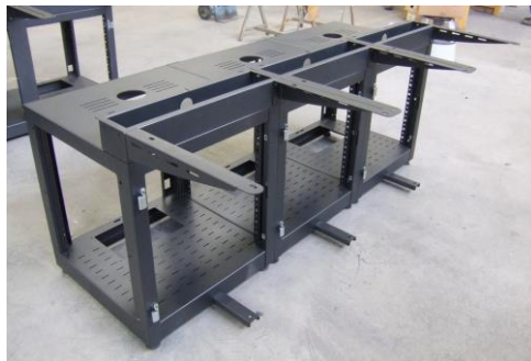
Caissons largeur 600mm assemblés entre eux.
