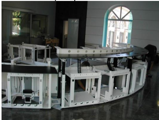
Console avec plan de travail et plan de pose des écrans monte et baisse. Vue arrière et côté opérateur
