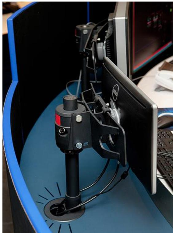
Le profil support d'écrans en acier peint est fixé sur le mat au travers d'une noix de serrage coulissante en aluminium, permettant le réglage en hauteur ainsi que l'inclinaison des écrans.
